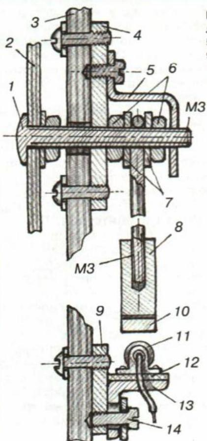
Рис. 5. Крепление и устройство маятника: 1 — ось; 2 — контур лошади; 3 — лицевая панель прибора; 4 — крепежная пластина; 5 — кронштейн; 6 — контровочные гайки; 7 — шайбы; 8 — груз; 9 — крепежная пластина герконов; 10 — магнит; 11 — геркон; 12 — изолятор; 13 — кронштейн геркона; 14 — регулировочный винт.
