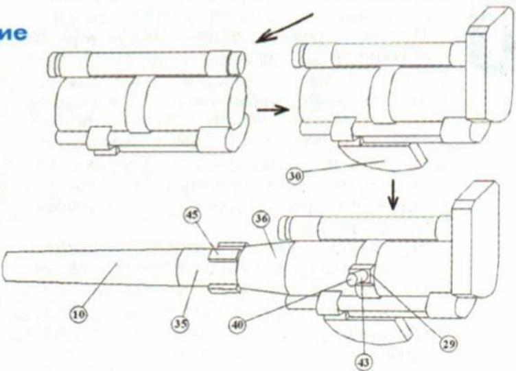
ее на стержень от гелевой ручки и склеив последние витки. В центральной части оси на обозначенных местах приклейте дет. 41, чтобы получились ограничительные утолщения. После этого наденьте на ось тележки с двух сторон.
