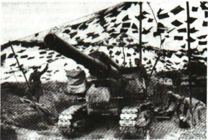
Самым тяжелым из советских полевых орудий времен Великой Отечественной войны была 203-мм пушка-гаубица образца 1931 года, имеющая обозначение Б-4. Она была предназначена для штурма крепостей, прорыва укрепленных полос, разрушения дзотов и дотов.
