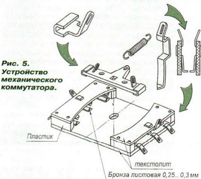
Виды движения двухдвигательного микроавтомобиля изображены на рисунках 4 и 5. На них видны варианты замыкания и размыкания управляющих контактов. Движение микроавтомобиля влево или вправо должно происходить одновременно с включением заднего хода одного из бортовых электромоторов.
