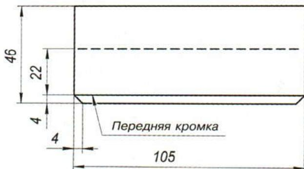
Рис. 15. Лопасть винта.
