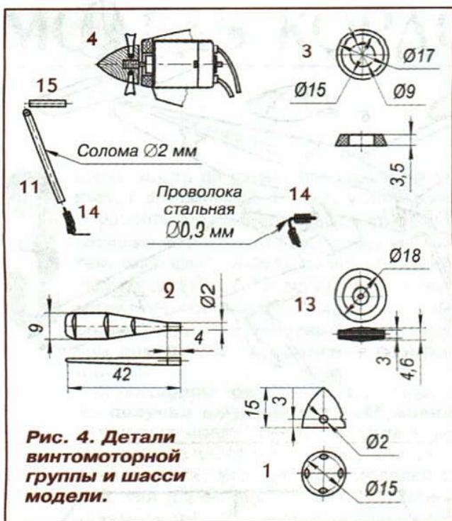
**Рис. 4. Детали винтомоторной группы и шасси модели.**
