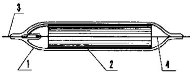
**Устройство стеклянного счетчика Гейгера — Мюллера:**
