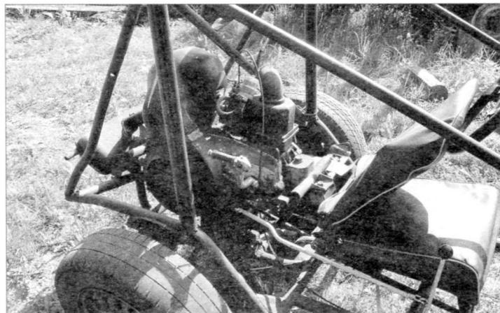
Вид силового агрегата слева и справа. Откидывающаяся спинка сиденья способствует удобному доступу к силовому агрегату
