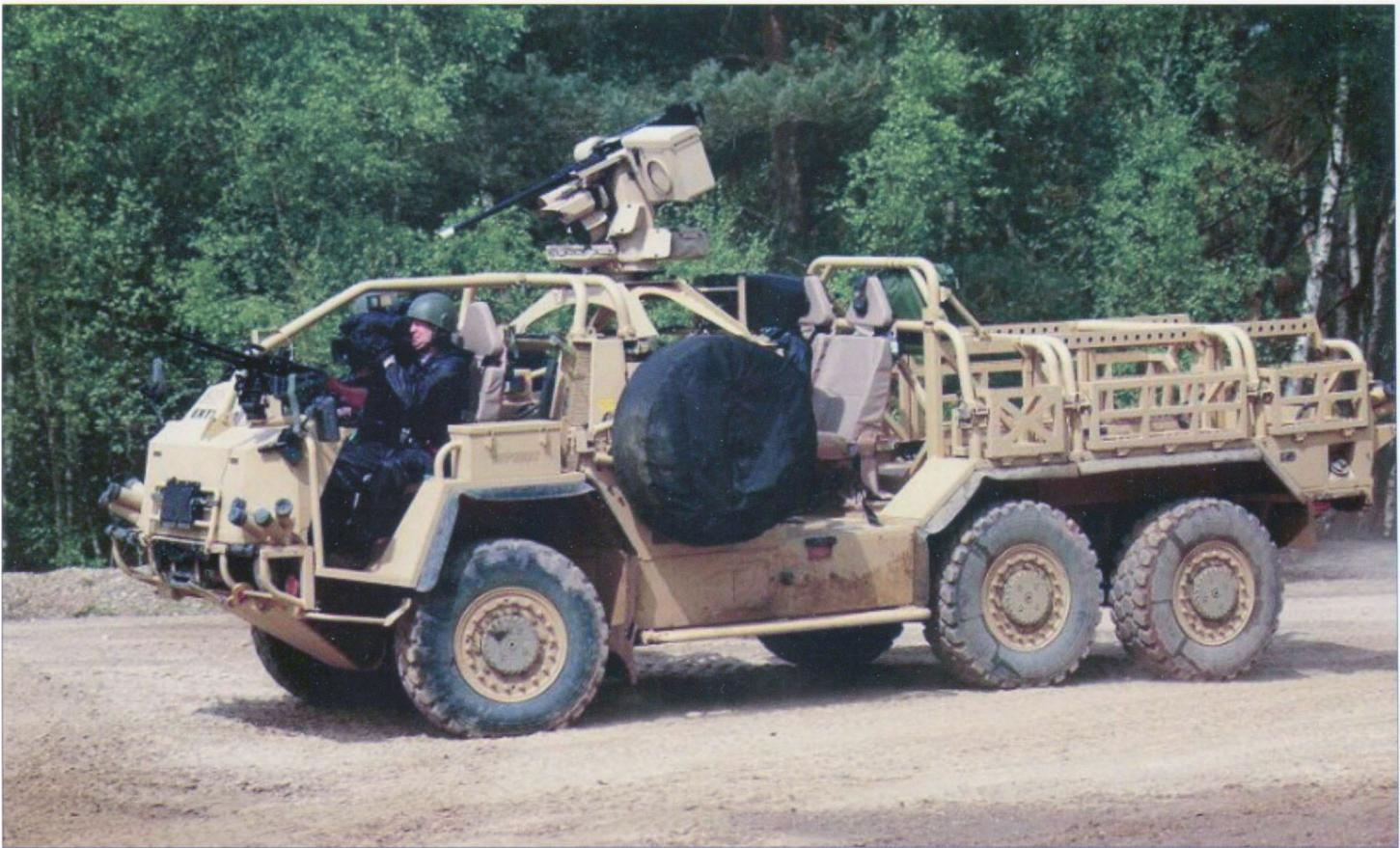
Бронеавтомобиль Supacat Extenda 6x6 британской армии
