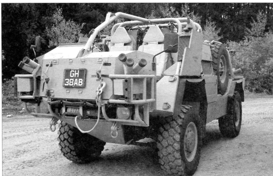
Корма бронеавтомобиля с установленной дополнительной броневой защитой и бронекреслами
