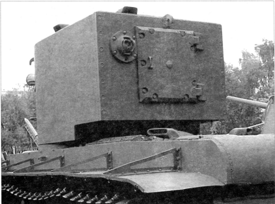
Корма башни. По центру находится люк для монтажа пушки, слева от него – амбразура кормового 7,62-мм пулемёта. Под башней – выхлопной патрубок двигателя
