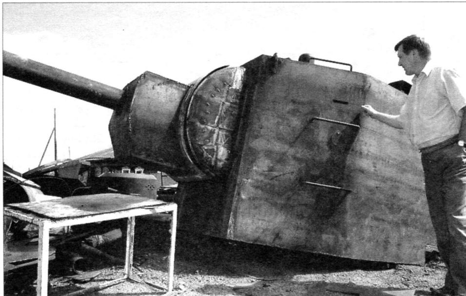
Башня КВ-2 поражала уже своим размерами – высота её равнялась 1,79 м. Внутренние габариты башни: длина – 2400 мм, ширина – 1745 мм. Для сравнения: стоящий рядом человек имел рост около двух метров. Башня танка – экспонат частного музея конструктора В. Вёровочкина, Новосибирск
