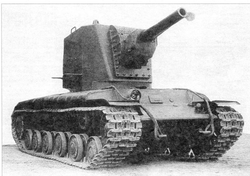
Опытный образец танка КВ-2. Отличается наклоном переднего броневого листа башни. Ствол пушки с заглушкой для предотвращения попадания в него пуль и осколков
