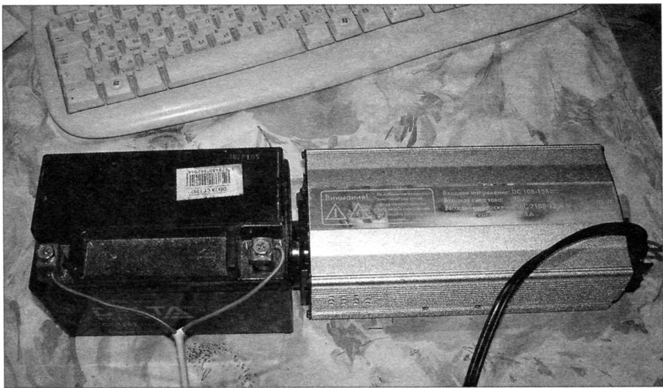
Преобразователь, подключенный к АКБ Delta CT 1207
