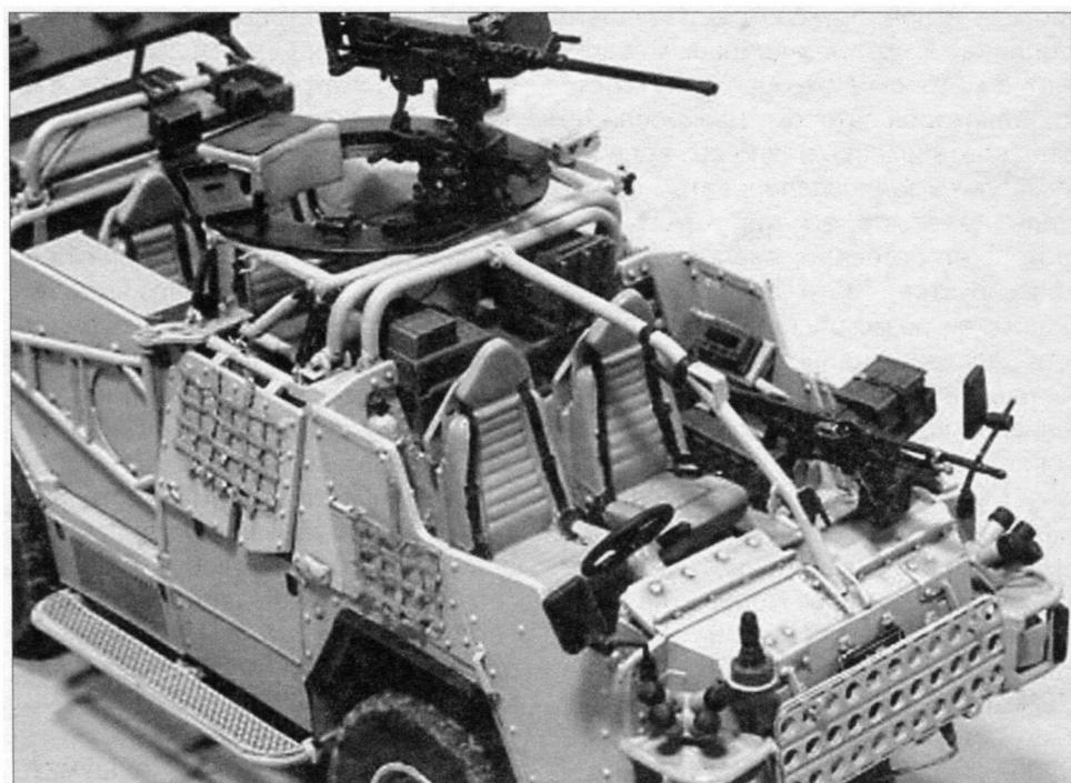
Вооружение броневика «Шакал» состоит из 7,62-мм командирского пулемёта GPMG и крупнокалиберного 12,7-мм HMG, находящегося в кормовой части на вращающейся турели, возможна установка 40-мм гранатомёта
