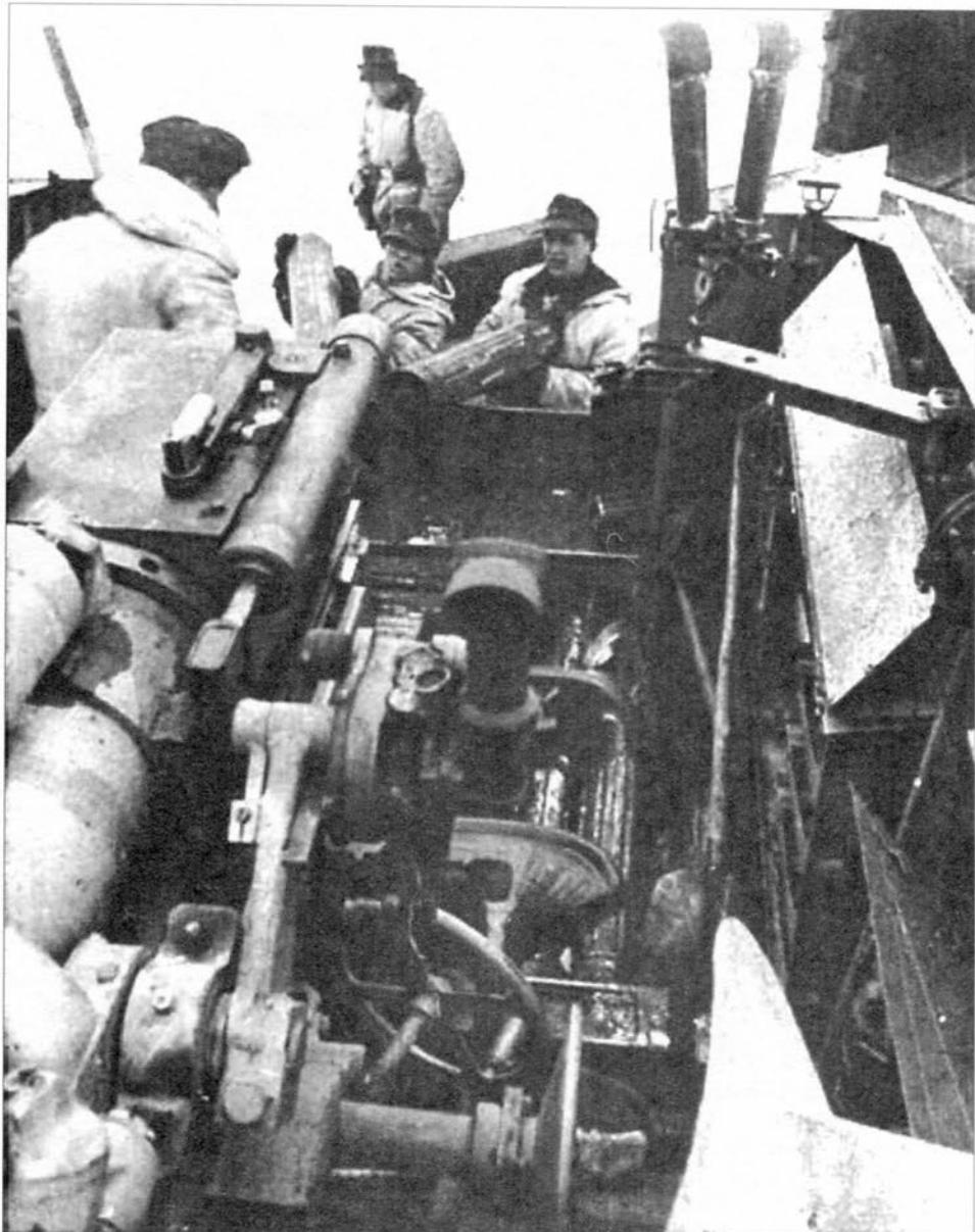
на высоте 2240 мм от уровня земли. Для устойчивого поддержания ствола при передвижении использовали устройство в виде «треноги» с автоматическим управлением из рубки.
