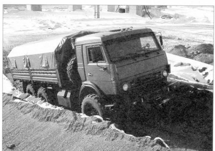
КАМАЗ-5350 на испытательном полигоне. Автомобиль с брезентовым кузовом
