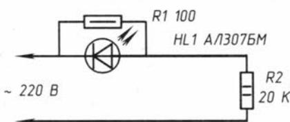
Рис. 1. Электрическая схема устройства локального нагрева
