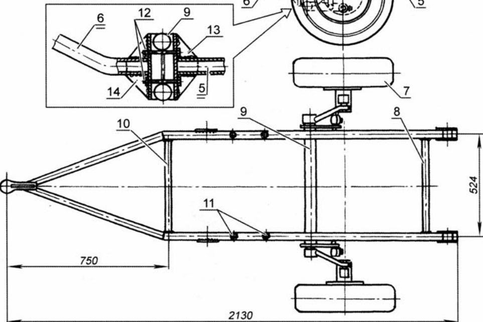
**Схема крепления штуцера подъёмного устройства:**
