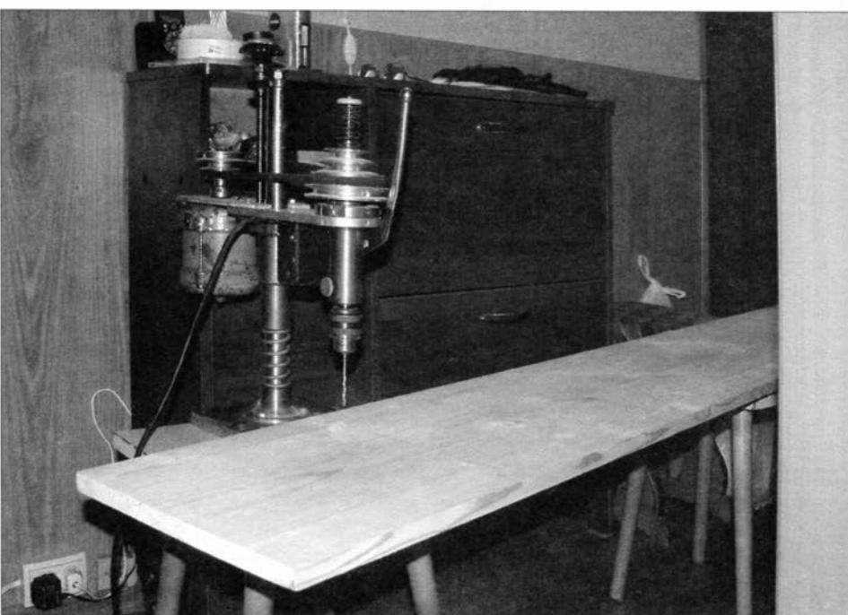
Отверстия в боковых стенках стеллажа сверлил на станке, предварительно уложив их горизонтально с помощью уровня
