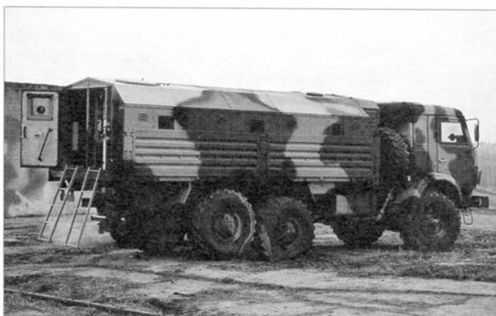
На военном КАМАЗ-5350 установлена бронированная кабина, защищает топливных баков, картера двигателя, аккумуляторных батарей. В кузове размещён защищённый кунг-модуль. Защита обеспечена по 5-му классу ГОСТ Р
