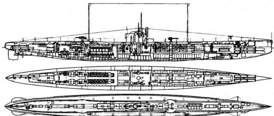
Подводная лодка «U-66» («Тип UD»), Германия, 1916 г.
