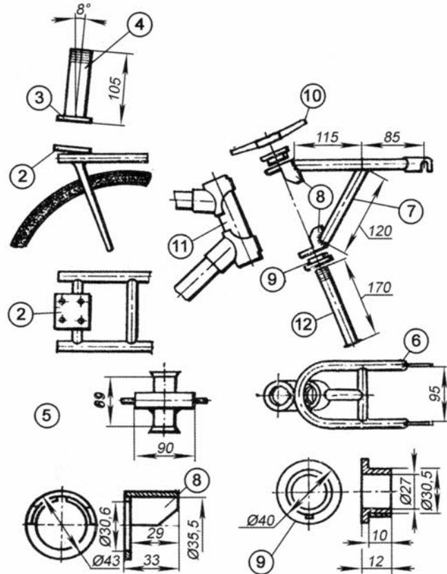
Схема скепного узла и его детали (размеры даны только лимитирующие):
