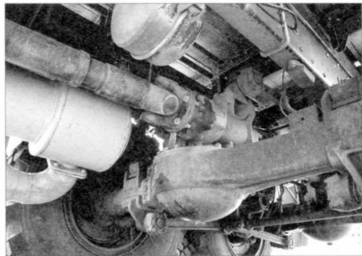
Задняя двухосная тележка автомобиля. На переднем плане средний мост и карданный вал привода моста
