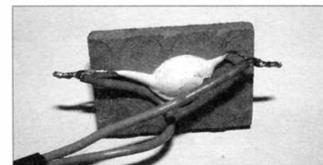
Рис. 3. Вид на приклеенный с тыльной стороны кафеля резистор R2
