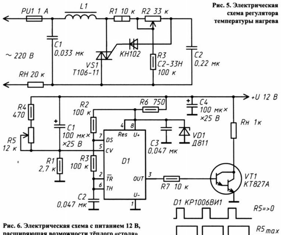
Рис. 6. Электрическая схема с питанием 12 В, расширяющая возможности тёплого «стола»
