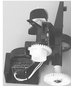
Рис. 4. Узел подачи бумаги из второго лотка
